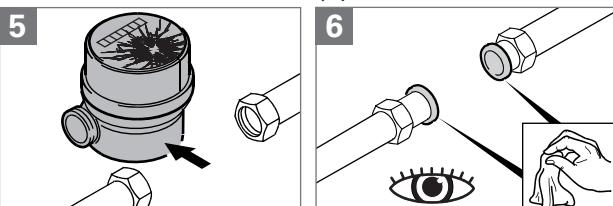
! При установке в пластмассовые трубопроводы использовать специально предусмотренные для этого уплотнения из EPDM (каучуковая резина).
