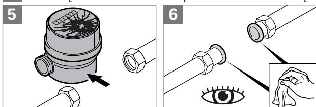
**!** Przy zabudowie w przewodach z tworzywa sztucznego(np. Nibco) zastosować specjalne uszczelki z EPDM.
