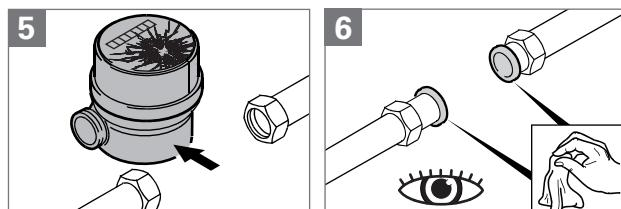
**!** Ved montering i plastrør skal der anvendes EPDM-pakninger, der er specielt beregnet til dette formål.
