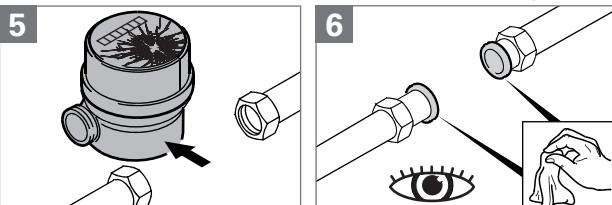
**!** Lors du montage dans des conduites en plastique, utilisez les joints EPDM spécialement prévus à cet effet.
