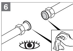
! Beim Einbau in Kunststoffleitungen die speziell dafür vorgesehenen EPDM-Dichtungen verwenden.
