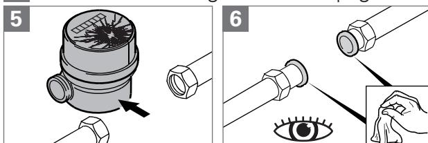
**!** Vid installation i plastledningar måste de för detta ändamål särskilda EPDM-packningar användas.
