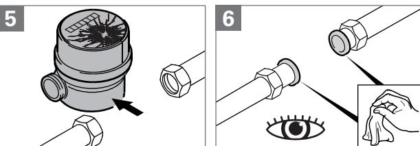
**!** A műanyag vezetékekbe történő beépítésnél használja a speciálisan erre a célra szolgáló EPDM tömítéseket.
