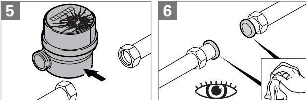
**!** Při montáži na plastové potrubí použijte EPDM těsnění určené speciálně k tomuto účelu.
