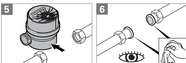
**!** Si se instalan tuberías de plástico, utilizar los sellos EPDM especialmente diseñados.
