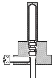
Bei längeren Tauchhülsen kann es vorkommen, dass die Befestigung nur noch am Kabel möglich ist. – Dabei das Kabel nicht beschädigen.
