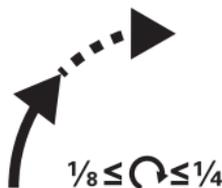
**15** Deslizar el anillo de sello de plomo con la llave de montaje sobre el contador hasta que este encaje.
